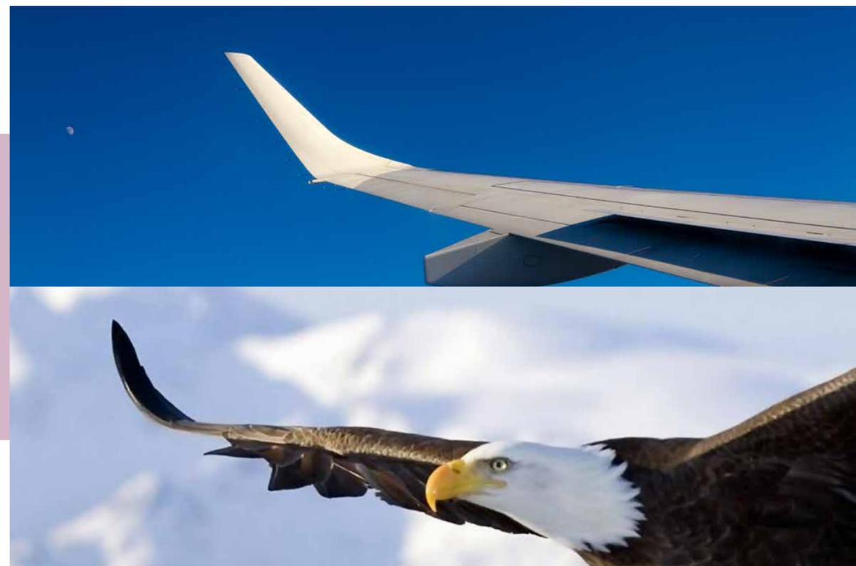
Vamos a um exemplo prático: nos últimos anos, a maioria dos aviões tem saído com um novo componente aerodinâmico - uma aba vertical ou inclinada na ponta da asa, o *winglet*. A peça tem a função de diminuir barulhos, trepidações e aumentar a sustentação. Também melhora a eficiência do voo, aumentando a velocidade e a economia de combustível.
