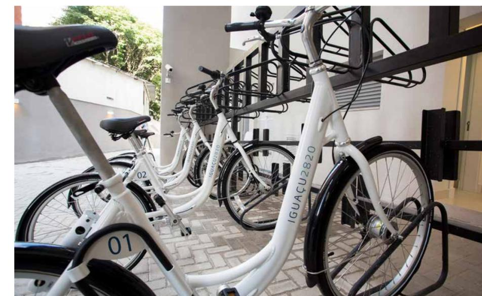
Para oferecer conforto e segurança, o design das bicicletas foi adaptado. Elas são compostas de três marchas, freio tipo rolete (tambor), transmissão sem uso de correntes (por meio de eixo cardã) e pneus anti-furos. A geometria foi pensada de modo a facilitar a postura durante a pedalada, evitando tensão sobre a área lombar da coluna, ombros e pescoço. Além disso, o guidão é mais alto para evitar contato com retrovisores de automóveis e possibilitar visão ampla da via.
